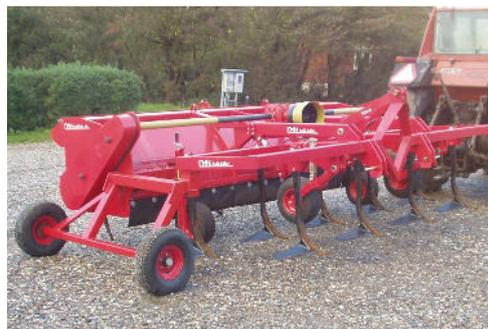
*KK400 mit Sicherungsbolzen auf Stoppelzahn und Bugsierung*
