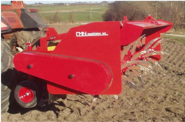
Das Quecken-Killer Modell *KKR* besteht nur aus Rotor und Spurenlöser. Vor der Anwendung dieses Modells muss das Feld mit einem Stoppelgrubber oder einem Pflug mit voller Durchschneidung gelockert werden.
