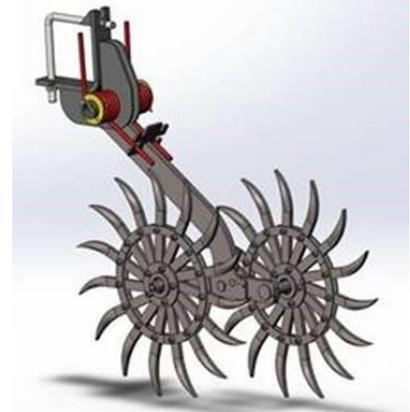
Der Druck auf die einzelnen Buggy-Aufhängungen kann durch einfaches Justieren der Federn in 4 verschiedene Positionen reguliert werden. Der Druck kann insbesondere bei Kartoffeln oder Spezialkulturen von großer Bedeutung sein.
