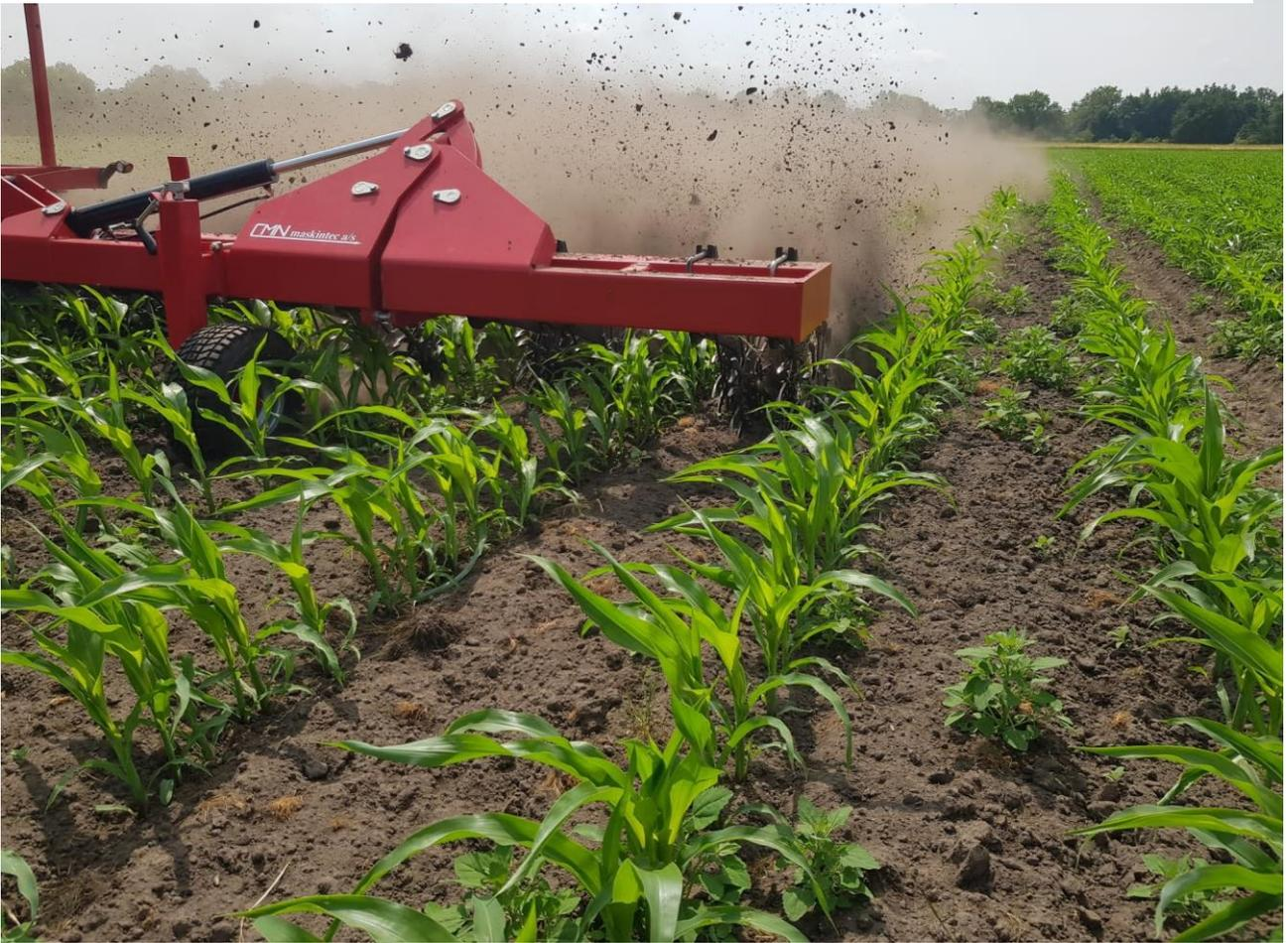
**CMN Star-cleaner** – Die optimale Lösung zum Umbrechen der Erdkruste sowie zur mechanischen Unkrautbekämpfung. Der CMN Star-cleaner mit Drei-Punkt-Aufhängung ist in 3, 6, 8, 9, 10 og 12m Arbeitsbreite erhältlich.
